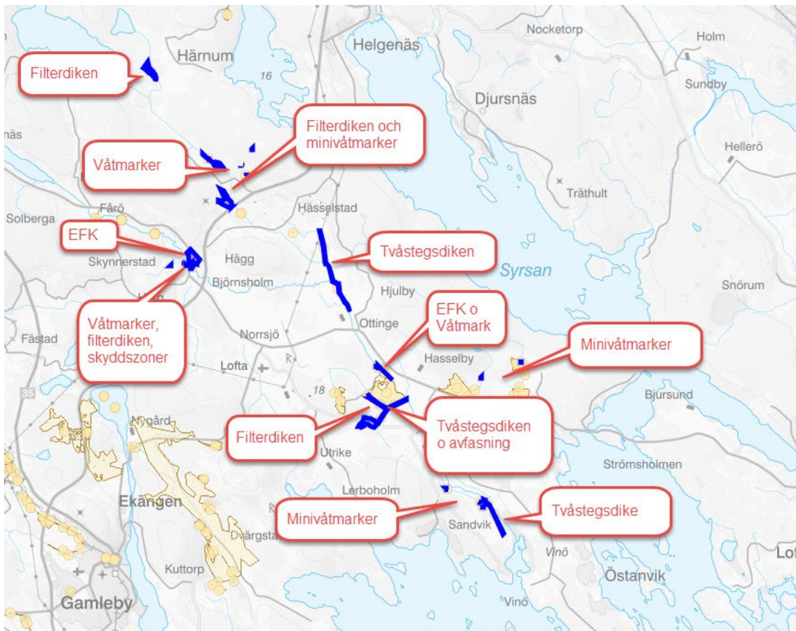
Åtgärder vid Loftaån
